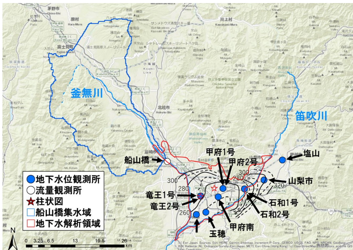
図-1 甲府盆地と国土交通省, 山梨県が管理している河川流量, 地下水位と柱状図の観測地点と 1974 年における地下水位等高線図 (東京通商産業局総務部開発業務課, 1977)
