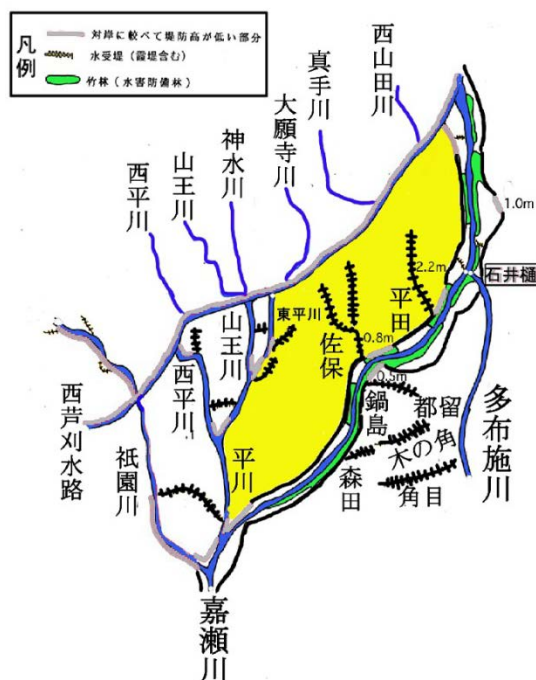
図-2 嘉瀬川右岸の本川越流型遊水地 (岸原資料) 3)
