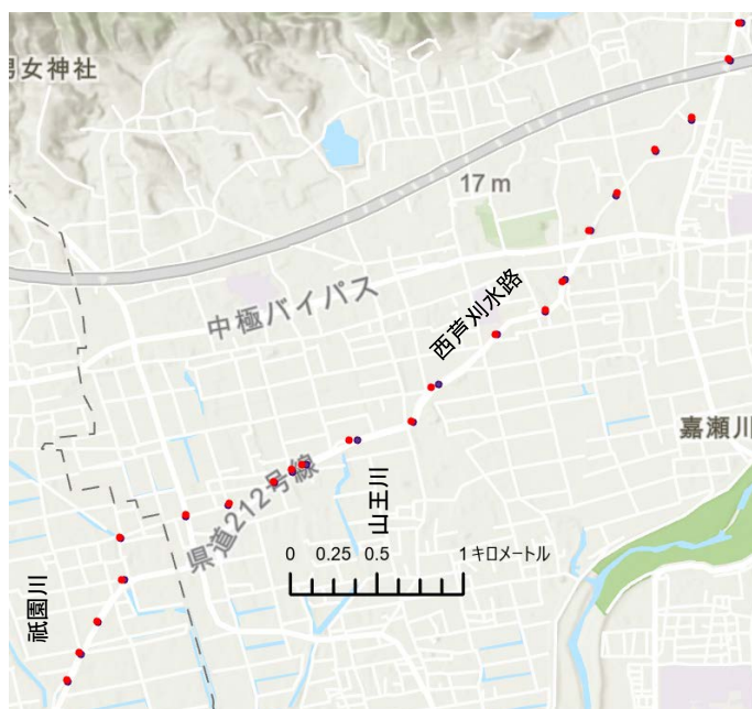
図-4 GNSSによる西芦刈水路の測量地点
