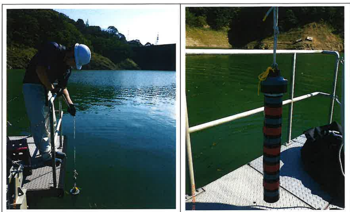
写真-2 遮光した状態（センサーをカバー）でアオコの計測をしている様子
