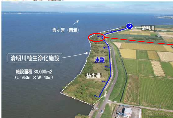
図2-1 湿地法の表面流れ方式のイメージ
